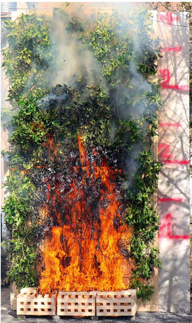
Abb. 6: Fotodokumentation des Brandversuchs Test 3 mit Holz- und Grünfassade zur dritten Prüfminute
