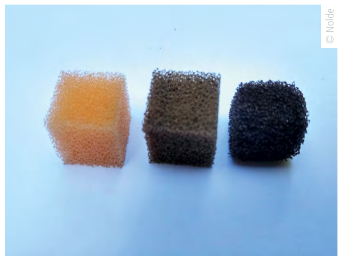
Abb. 3: Schaumstoffwürfel als Trägermaterial für die Biologie in den Behältern der Aufbereitungsanlage. Links fabrikneu, mittig und rechts mit Bewuchs in getrocknetem Zustand nach 16 Jahren ununterbrochenem Betrieb in einer Berliner Anlage, die im Wirbelbettverfahren Grauwasser reinigt.
